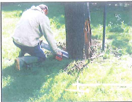
Foto n. 2: esempio di rilievo con resistograph.
